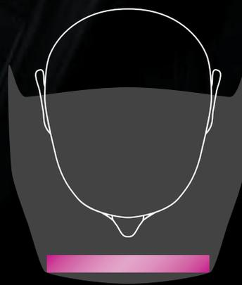
Ein erweitertes Sichtfeld mit einem flachen Schweißfilter erfordert eine breitere Maske.
