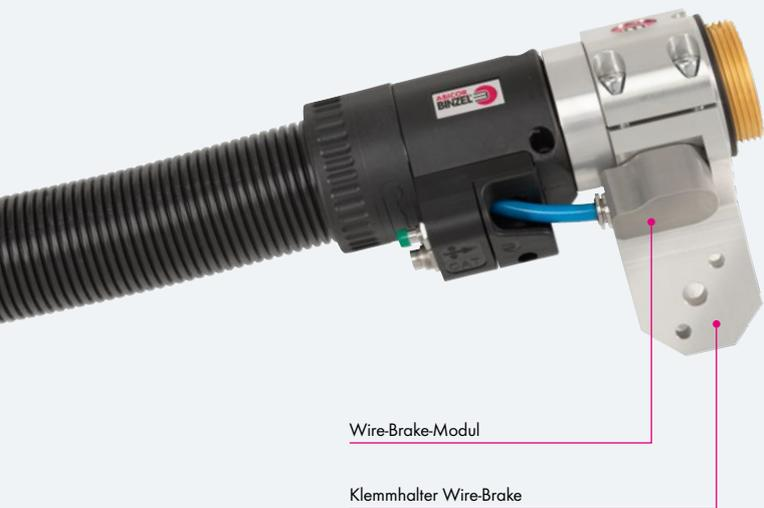
Für die taktile Bauteilsuche mittels Schweißdraht sind die bewährten ABIROB® W-Schlauchpakete optional mit einer Wire-Brake zur Fixierung des Drahtes im Schlauchpaket erhältlich. Diese Funktion ermöglicht es, den Draht im Schlauchpaket zu arretieren, indem der Schweißdraht durch Pneumatikzylinder geklemmt wird. Dies verhindert die Bewegung des Schweißdrahtes während der Roboterfahrbewegung.
